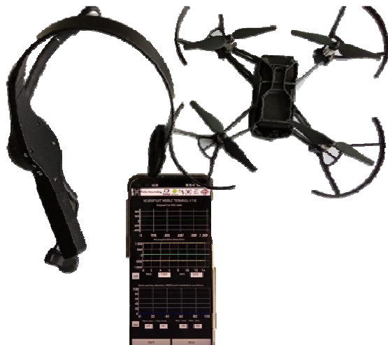
Рис. 4. Готовый комплект программно-аппаратного решения для управления дроном с использованием нейроинтерфейса на основе ЭЭГ
